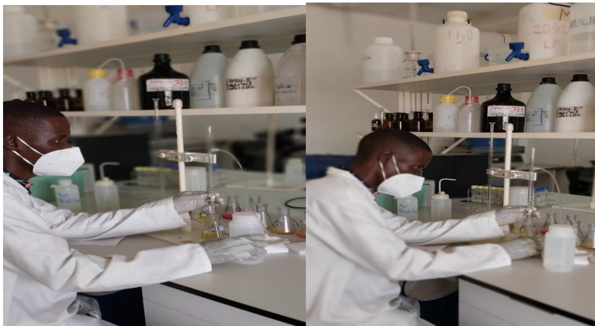
Figura 16. Análise de nitrogénio total pelo método de titulação
